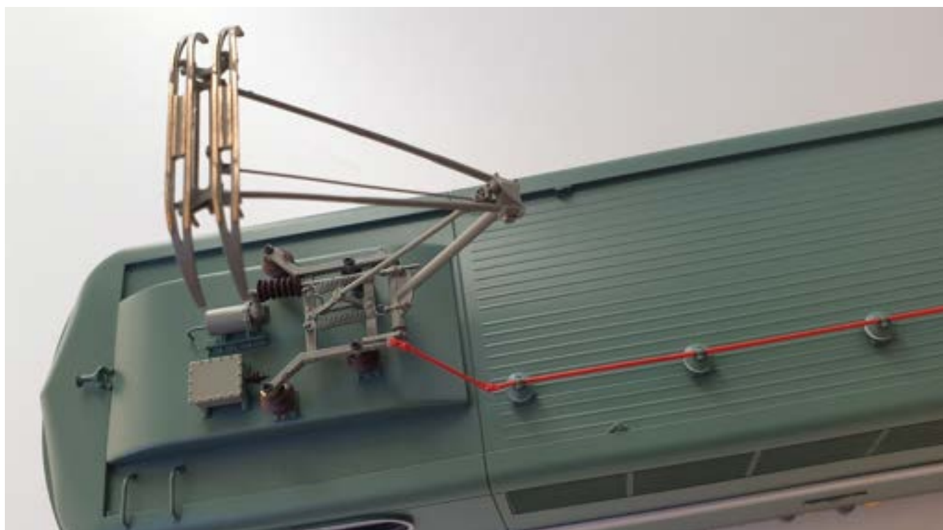
Pantographe AM 14 sans renfort de cadre
