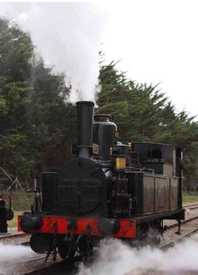
Deux locomotives aussi essentielles au Train des mouettes que gourmandes, la locomotive diesel, 10 000 litres par an, et la Schneider 030T, 10 kilos de charbon au kilomètre. PHOTO R.C.
