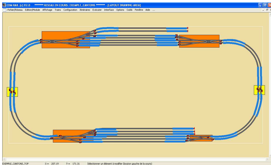
Figure 12: exemple de rétrosignalisation basée sur des détecteurs de zones.
