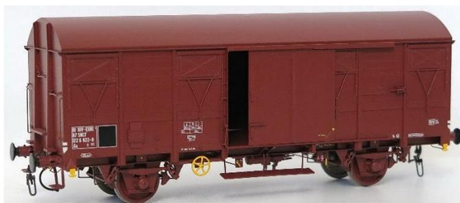
Les couverts G4.2 seront la première réalisation d'AMJL à cette échelle. Les travaux faits sur le modèle au 1/43.5° permettent d'extrapoler aisément une petite série au 1/32° en y incorporant quelques détails plus élaborés (volets mobiles, essieux sur roulements à billes, boyaux de freins souples, plancher bois, ...) que cette plus grosse échelle permet de réaliser.
