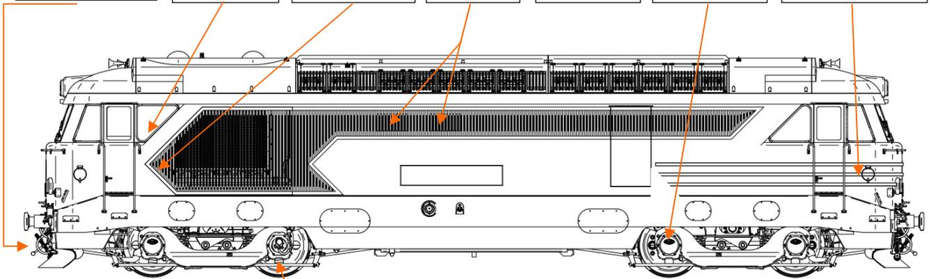
La prise de mouvement de l'enregistreur de vitesse sera correctement disposée sur la boîte d'essieu N°3 (ici dessinée sur la N°4)
