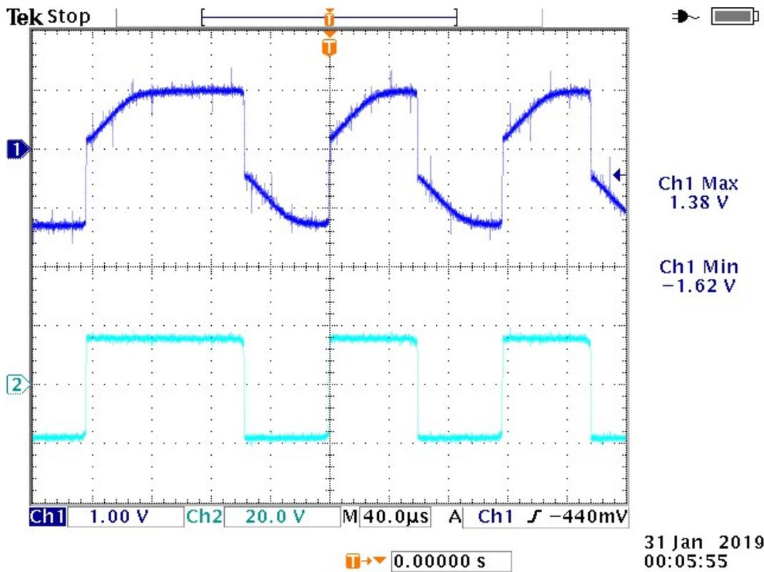
Câble de 2 mètres pas de résistance, capas de 47nF sur le détecteur
