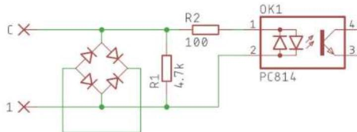
Le courant vers la piste va de C, à travers le redresseur pleine onde (deux diodes en série), à 1. Le pont limite la tension sur R1 à environ  $\pm 1,2$  V. 100 ohm La résistance limite alors le courant via les LED de l'optoisolateur (le numéro de pièce de l'isolateur n'est probablement pas celui utilisé dans le DR4088).
