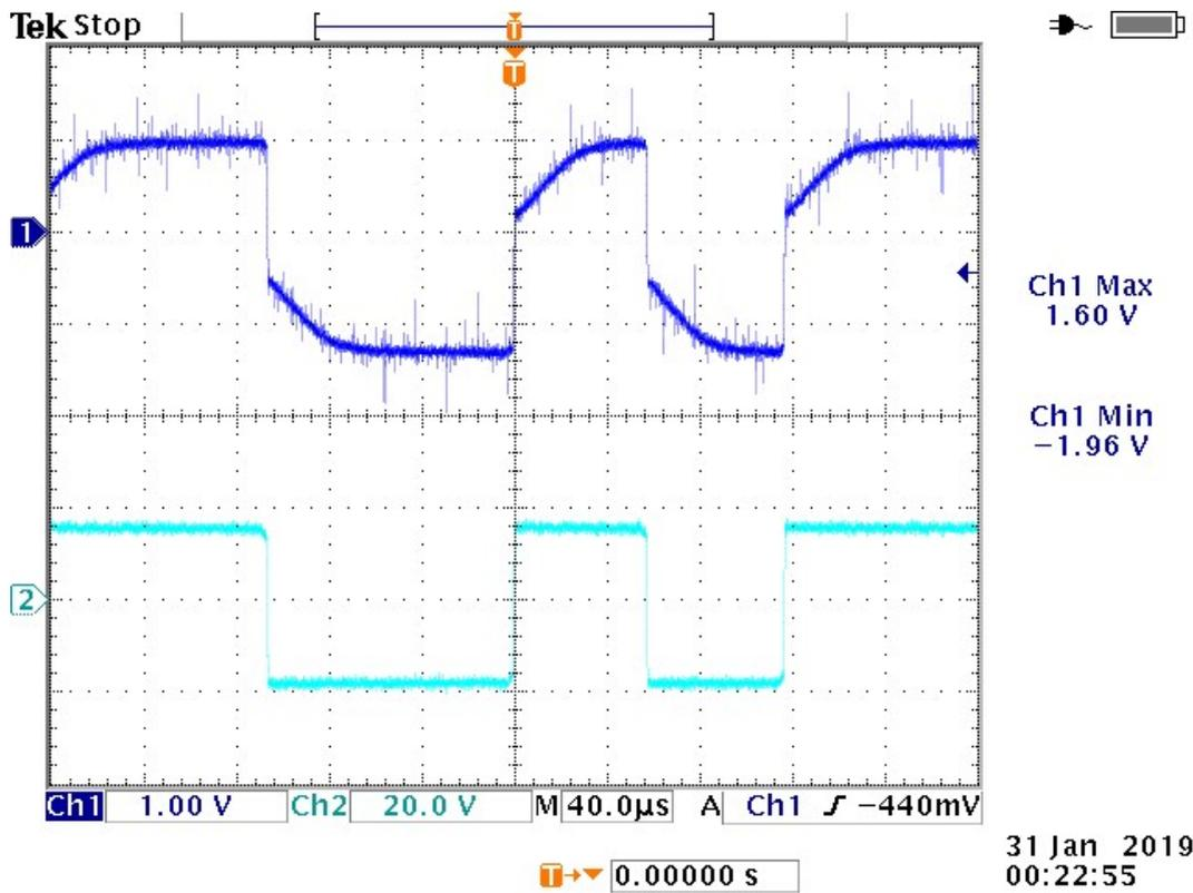
Câble de 2 mètres avec résistance 10k, capas 2.2nF à l'extrémité du câble et 47nF sur le détecteur.
