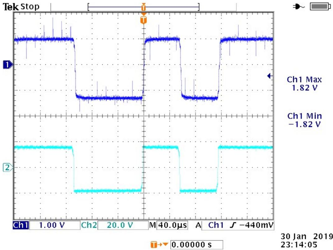
Câble de 2 mètres avec résistance 10k et capa 47nF sur le détecteur
