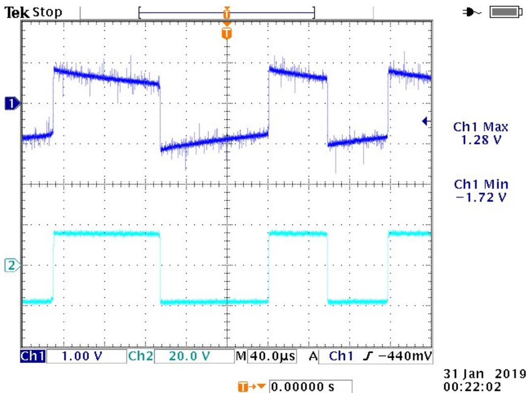
Câble de 2 mètres pas de résistance, capas de 2.2nF à l'extrémité du câble et 47nF sur le détecteur.
