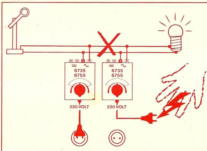
Dies kann dazu führen, daß man mit der Netzspannung von 220 Volt ~ in Berührung kommt, wenn nur ein Trafo an der Netzsteckdose angeschlossen ist und der Netzstekker eines anderen Trafos in die Hand genommen wird.
